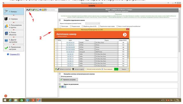
3 Найдите вашу камеру Amatek в списке по IP адресу (в примере камера с IP адресом 192,168.230.150) и выберите камеру, установив напротив неё галочку (3). Для добавления камеры в вашу видеосистему на ПО «Масгосор» нажмите иконку «Добавить устройство» (4).
