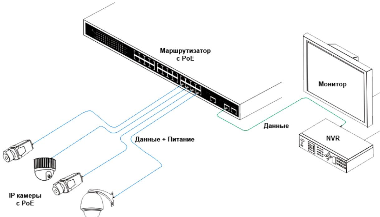
Рис 3. Схема подключения
