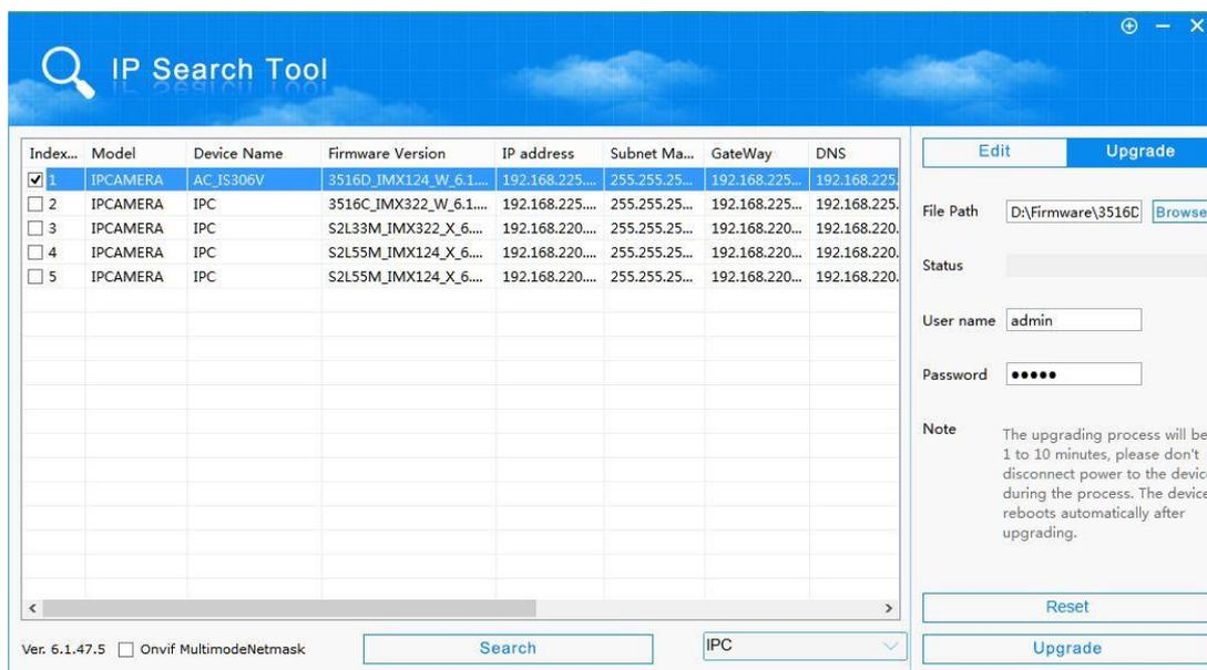
**Примечание:** Процесс обновления прошивки может занимать от 1 до 10 минут. Пожалуйста, не выключайте питание устройства во время всего процесса обновления. Устройство автоматически перезагрузится после завершения процесса.
