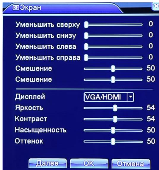
Рис. 3.19 Настройка выходного сигнала
