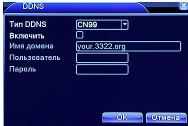
Рис. 4.22 Установка DDNS
