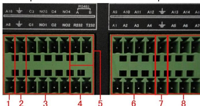
①⑥⑧ Вход сигнала тревоги, ②⑦Заземление, ③Выход сигнала тревоги, ④RS232, ⑤RS485
