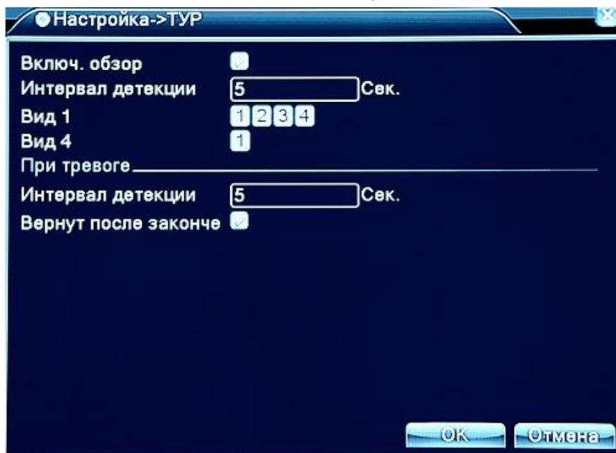
Рис. 4.31 Настройки Тура обзора каналов
