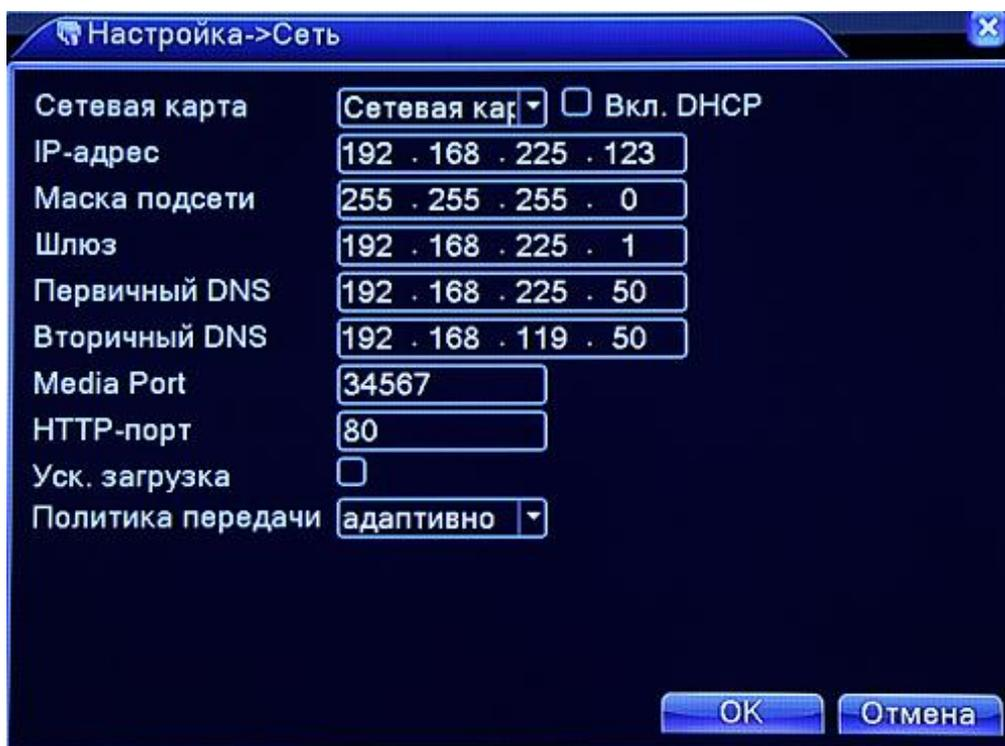
Рис. 4.16 Сетевое соединение
